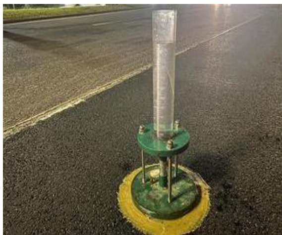
图 1 现场渗水检测
