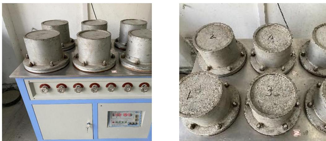
图 5.10 固废小型构件抗渗试验
