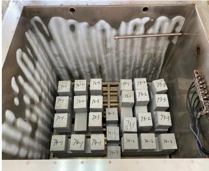
图 5.11 固废小型构件抗冻试验
