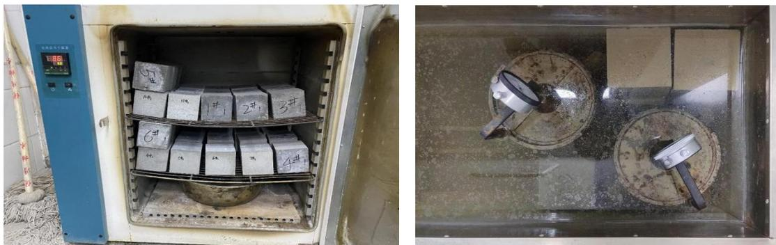
图 5.12 固废小型构件高温稳定性试验
