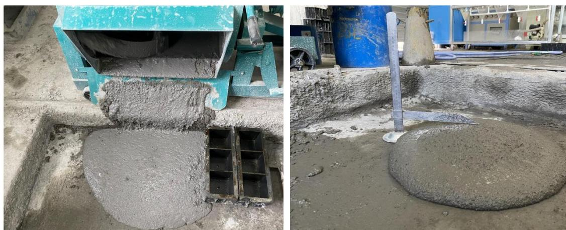
图 5.6 固废复合矿物掺合料-钢渣 M30 砂浆工作性
