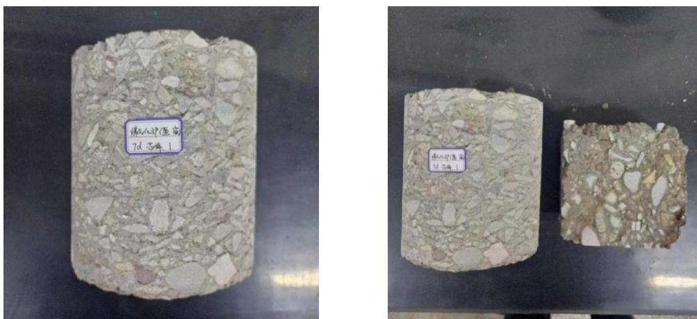
图 5-12 水泥稳定煤气化炉渣碎石底基层试验段取芯
