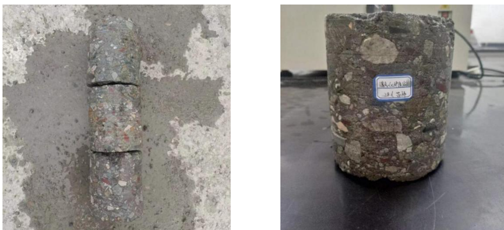
图 5-13 水泥稳定煤气化炉渣碎石底基层试验段取芯
